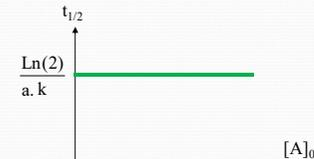
**Temps de demi-réaction indépendant de  $[A]_0$  pour les réactions d'ordre 1**
